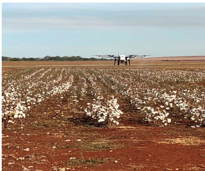
Figura 16 – Aplicação de inseticida experimental com drone em algodão. Cambará. Julho 2018.
