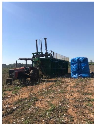
Fotos de colheitadeira e de prensa para formação dos fardões e de fardo prensado e pronto para envio a algodoeira.
